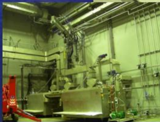
Anlagen zur elektrolytischen und chemischen Dekontamination metallischer Reststoffe mit internen Wasser- aufbereitungsanlagen
