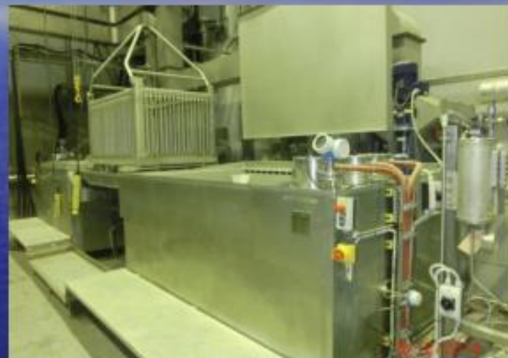
Anlagen zur elektrolytischen und chemischen Dekontamination metallischer Reststoffe mit internen Wasser- aufbereitungsanlagen
